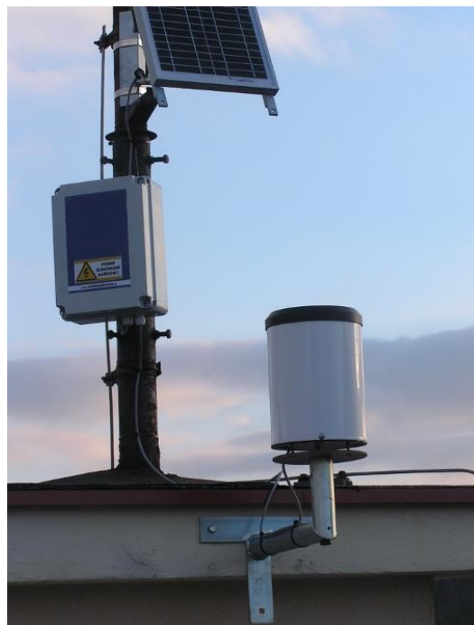
Příklady instalace srážkoměrných stanic - na zemi a na budově se solárním panelem
