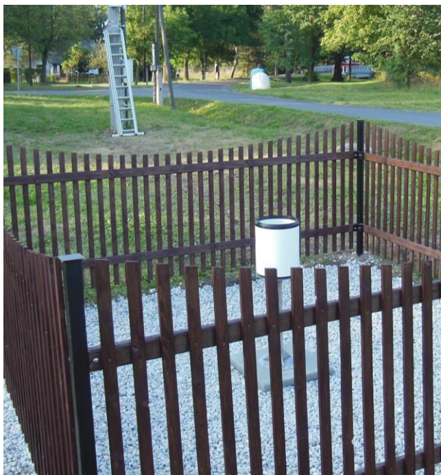
Příklady instalace srážkoměrných stanic - na zemi a na budově se solárním panelem
